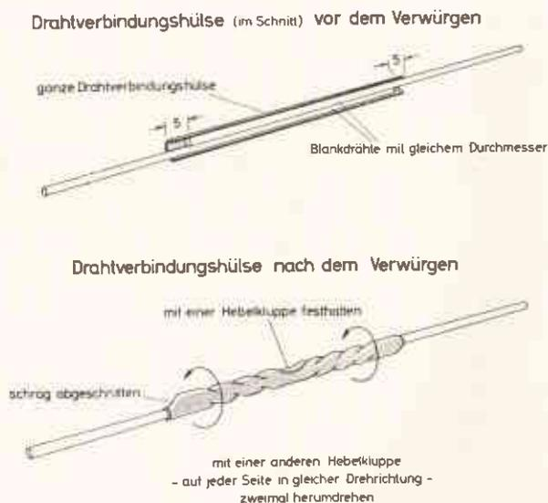
Abb. 14.27 — Verbindung von Blankdrähten durch Hülsenbund
