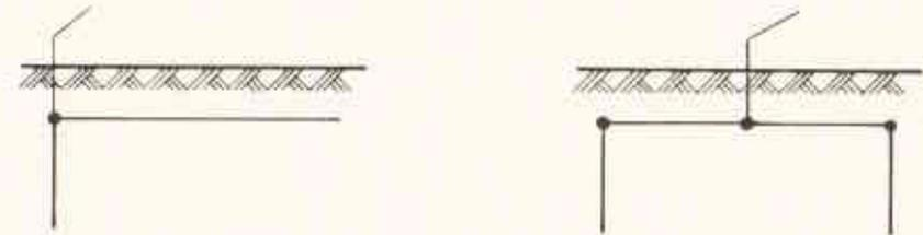
Abb. 22.4 — Kombiniertes Erder — Tiefen- und Oberflächenerder
