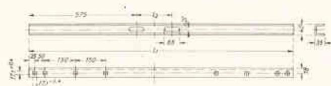
Abb. 12.8 — Querträger C ... für A-Maste
