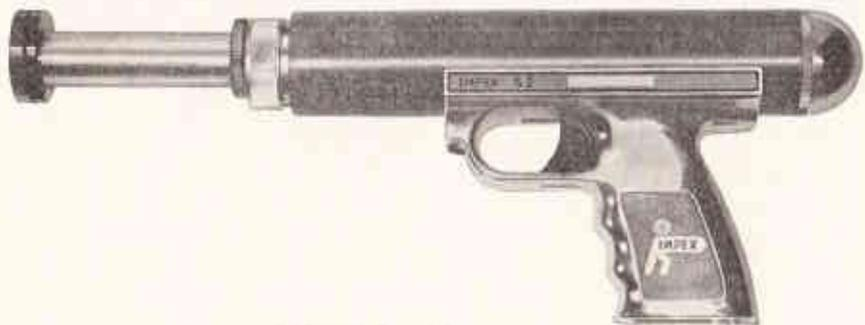
Abb. 21.9 — Bolzenschubwerkzeug mit Abzug „Impex S 2“
