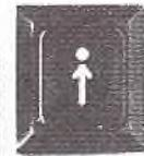
Wenn Sie die Kurzwahl benutzen möchten, heben Sie zunächst den Hörer ab, warten auf den Wählton und drücken kurz die Speichertaste. Anschließend die Zifferntaste der gewünschten Rufnummer (z. B. die 1). Jetzt wird die gespeicherte Rufnummer ausgesendet. Nach dem Gespräch legen Sie einfach auf.
