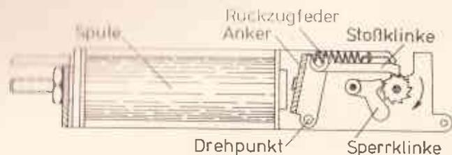
Der Anker betätigt über eine Stoßklinke das Zählwerk, das aus fünf oder sechs Zifferntrommeln besteht. Die Spule hat zwei Wicklungen (200 Ohm und 1800 Ohm), die an drei Löt-fahnen liegen.
