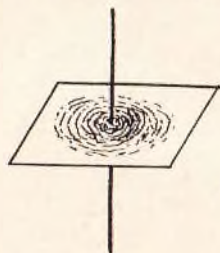
Abb. 82 a Magnetfeld eines geraden Leiters
