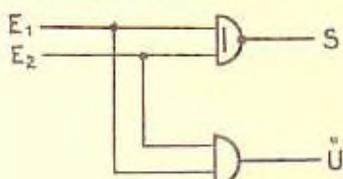
Die Funktion eines Halbaddierers kann auch durch das folgende Symbol ausgedrückt werden:
